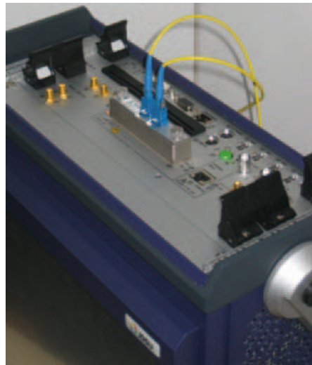
Optischer Netztester ONT-503 mit 100-Gigabit-Ethernet-Modul und CFP
