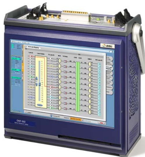
Optischer Netztester ONT-503 unterstützt auch 100-Gigabit-Ethernet
