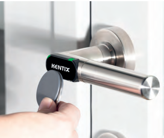
Buchung am Online-Türdrücker mit RFID-Token zum berührungslosen Entriegeln der Tür.
